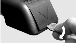
De batterijhouder dient door middel van een muntstuk aan de kop van het handmatige apparaat geopend te worden. De verbruikte batterij dient aan het regionale recyclagesysteem overgedragen te worden.
